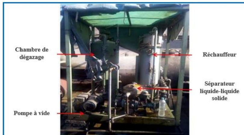
Figure 3. 4 : Photo de l'appareil centrifugeuse (Marque ALFA-LAVAL).
