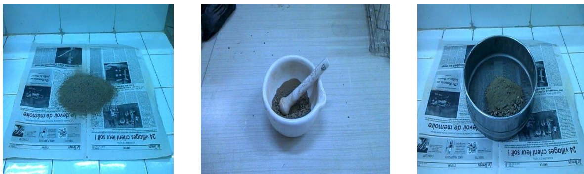
Fig.14 : Phase de séchage, broyage et tamisage des échantillons de sol au laboratoire.
