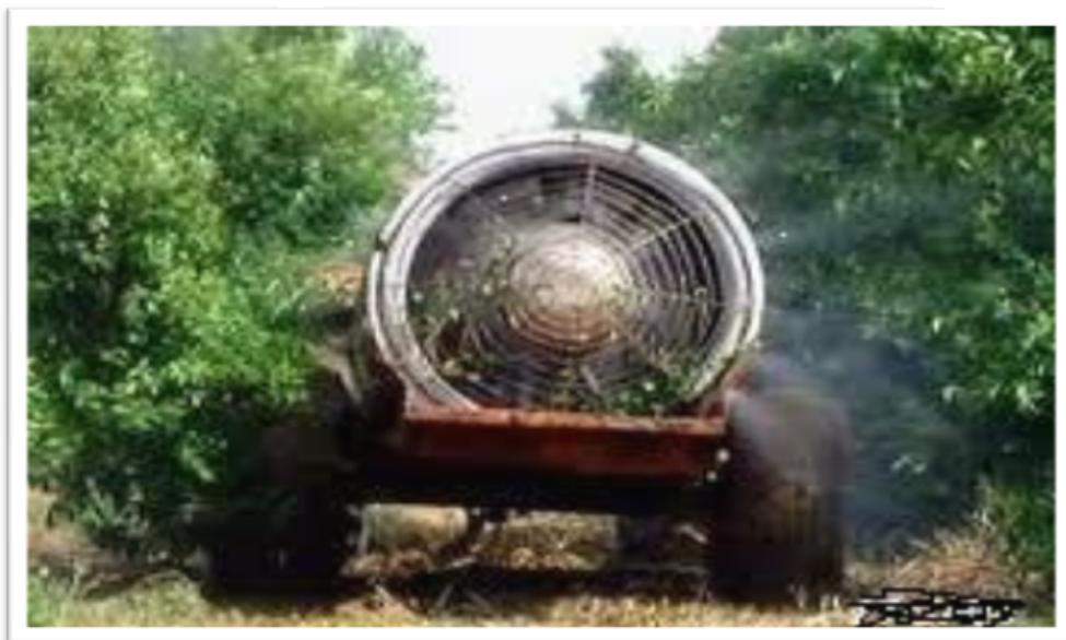
**Figure 16: Réalisation d'un traitement par un pulvérisateur de type atomiseur. (Anonyme, 2017)**
