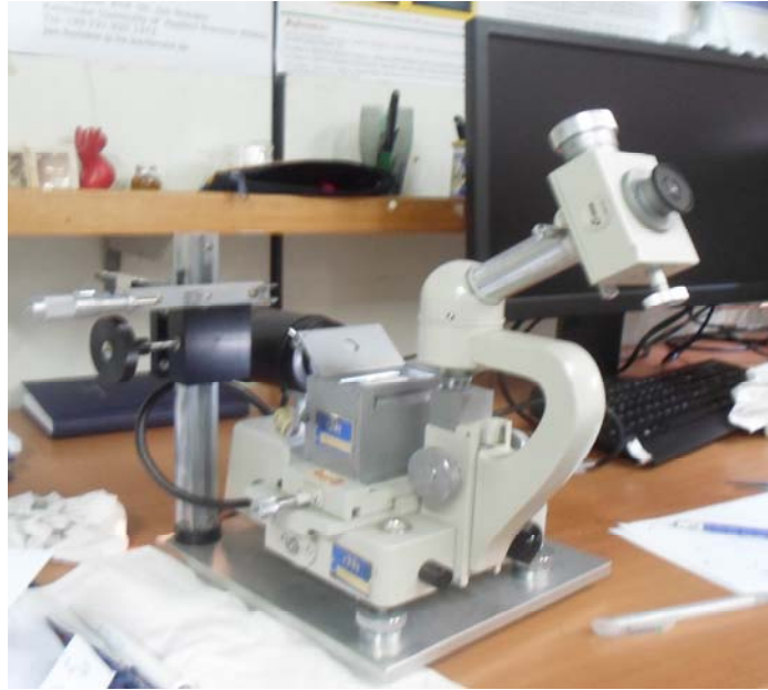
Figure 2.5. Tensiomètre optique pour la mesure de l'angle de contact
