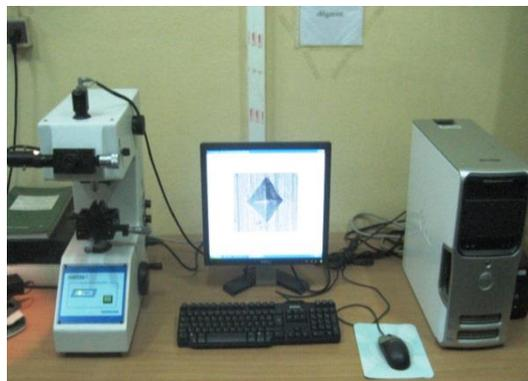
Figure 2.21 : Dispositif de mesure de la microdureté.
