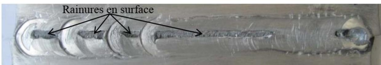
Plaques 10 mm,  $N=1050$  tr/min,  $V_a=0.6$  mm/s,  $\theta=2^\circ$ .
