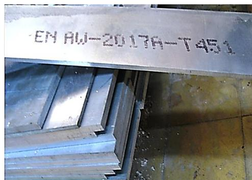
Figure 2.1 : Alliage 2017A-T451 sous forme des tôles laminées.
