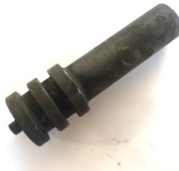
Figure 2.5 : Outil FSW après traitement thermique.
