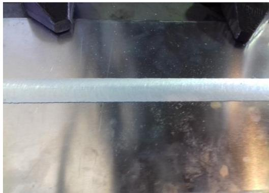
Figure 2.11 : Joint soudé par FSW final.
