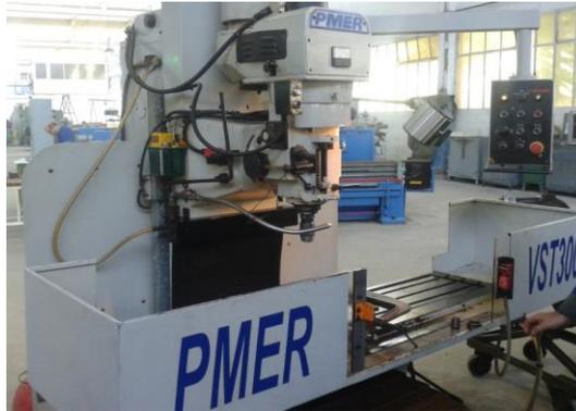
Figure 2.6 : Fraiseuse utilisée pour le soudage FSW.
