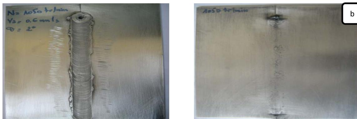
Figure 3.2 : Plaques d'aluminium 2017A-T451 de 6 mm d'épaisseur soudées par FSW avec les paramètres  $N=1050$  tr/min,  $V_a=0.6$  mm/s et  $\theta = 2^\circ$  : (a) côté joint, (b) côté opposé.
