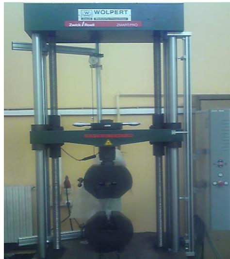
Figure 2.23 : Machine utilisée pour l'essai de traction WOLPERT-AMSLER ZZ220.
