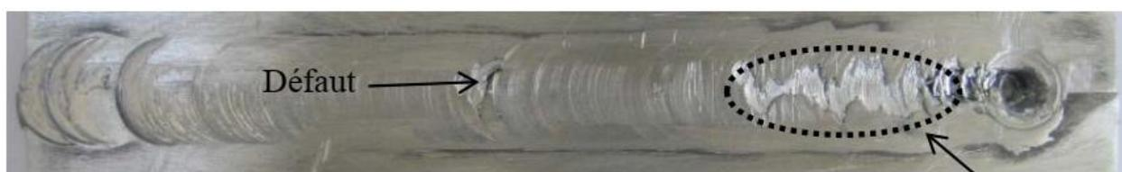
Plaques 6 mm,  $N=1050$  tr/min,  $V_a=0.6$  mm/s,  $\theta=2^\circ$ .
