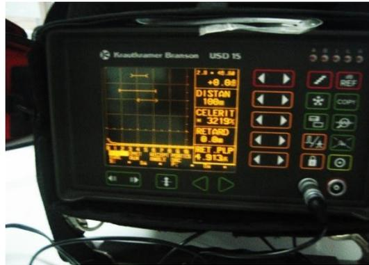
Figure 2.15 : Appareil à ultrasons : Krautkramer Branson USD 15.
