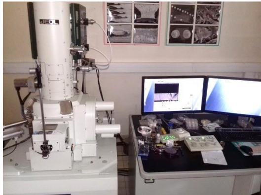
Figure 2.17 : Microscope Électronique à Balayage « JSM-7100F ».
