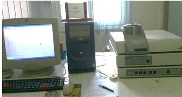
Figure 2.20 : Préparation des échantillons pour l'analyse par DSC 204.
