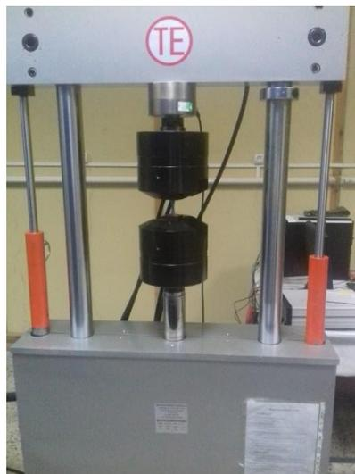
Figure 2.26 : Machine hydraulique de Fatigue « PLS-100 ».
