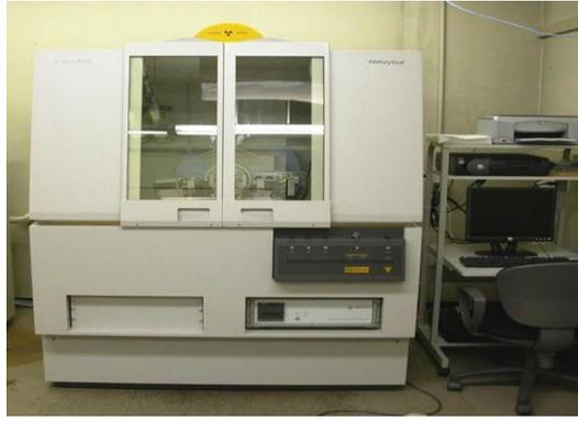
Figure 2.18 : Diffractomètre de type « X'PERT-PRO ».
