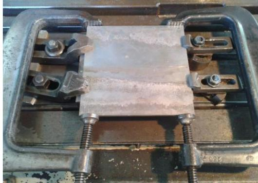
Figure 2.7 : Dispositif de fixation des plaques à souder.
