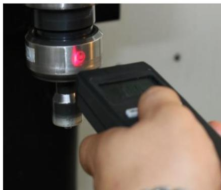
Figure 2.9 : Réglage de la vitesse de rotation de l'outil.
