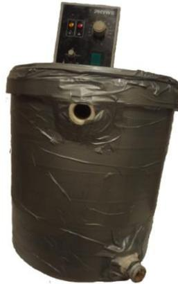
**Figure III.2 : Système de chauffage**
