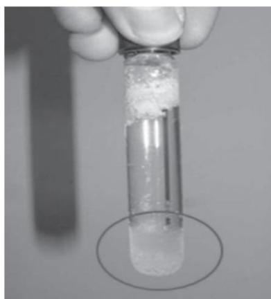
**Figure II.5 : Fusion incongruente d'un sel hydraté (Streicher, 2006)**
