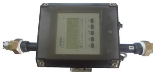
**Figure III .6 Débitmètre à électromagnétique**
