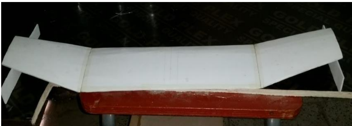
Fig.V.12 : l'assemblage de l'aile
