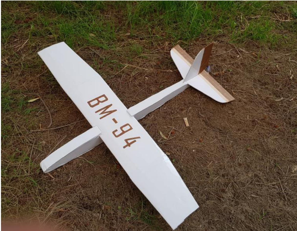
Figure (V-16) : Assemblage final de BM-94.
