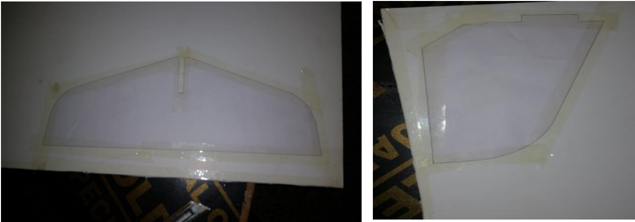
Fig.V.13 : Découpage d'Empennage vertical et horizontal
