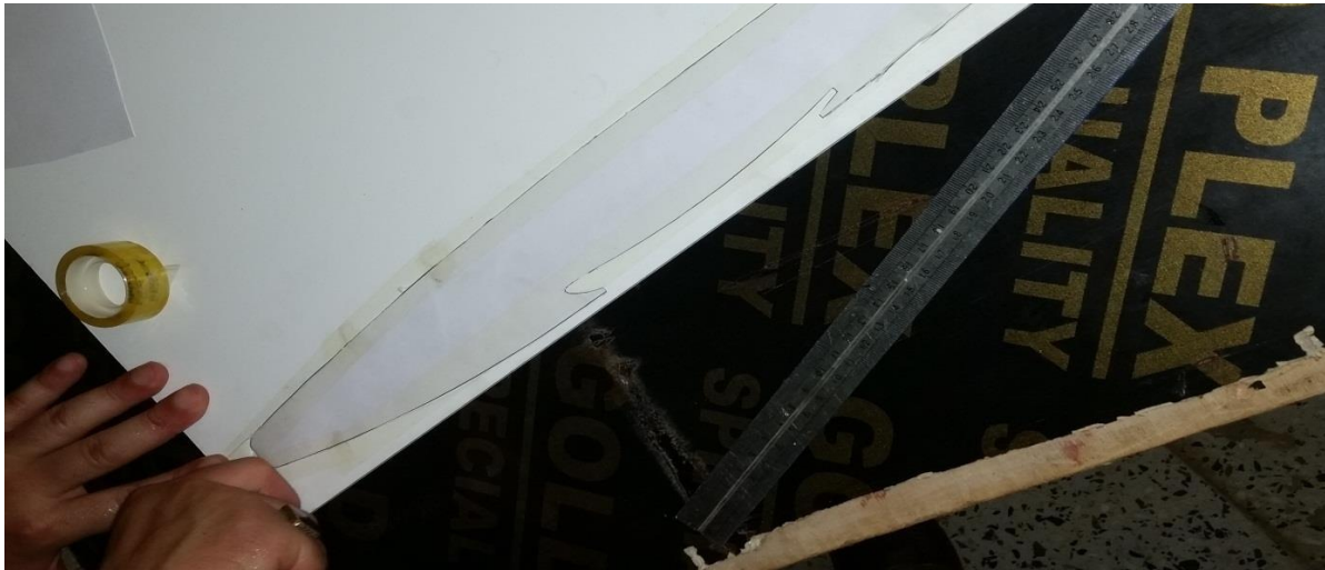
Fig V.6 :Découpage du fuselage
