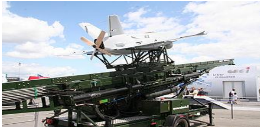
Figure I.19 : Catapultage opérationnel d'un Sparwer
