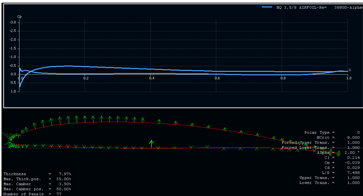
Figure (III-7): la variation de pression, la ligne de la corde et les conditions de décrochage de profil HQ3.5/8 pour \alpha=2^\circ .
