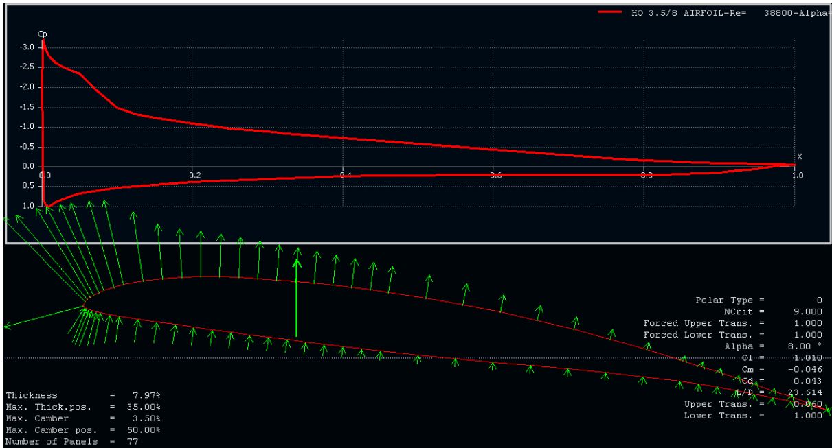
Figure (III-6): la variation de pression, la ligne de la corde et les conditions de décrochage de profil HQ3.5/8 pour \alpha=8^\circ .
