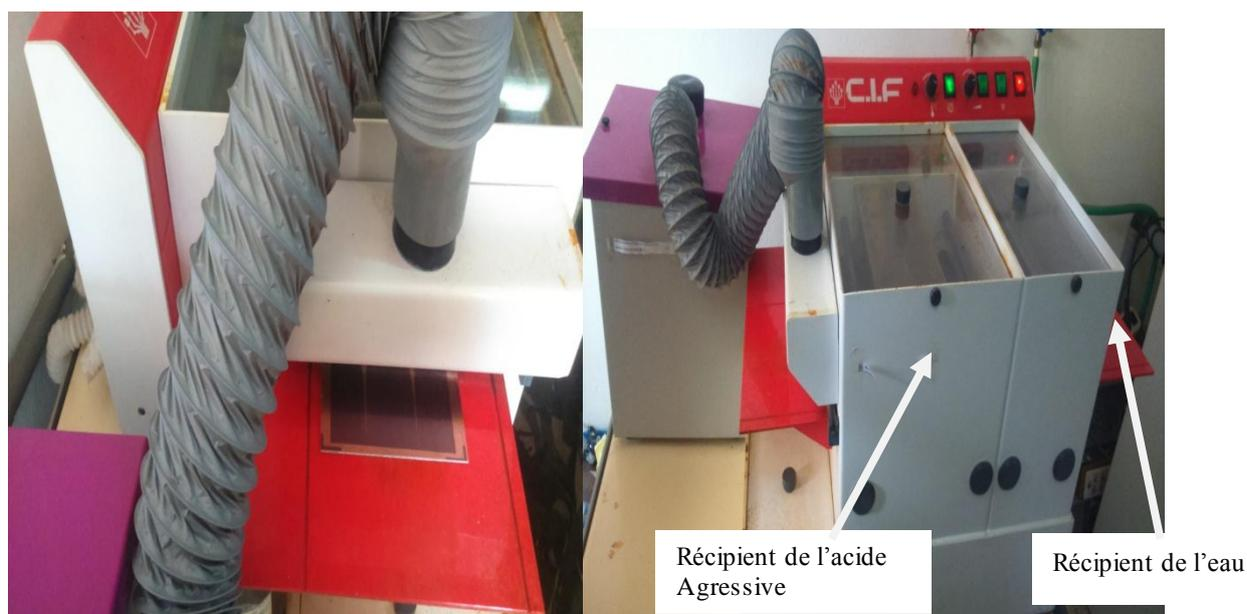
**Figure III.33:** La machine de gravure chimique.
