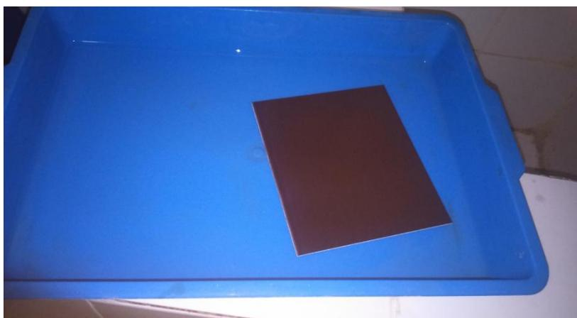
**Figure III.32:** plaquette noyée dans une baignoire d'un dissolvant chimique.
