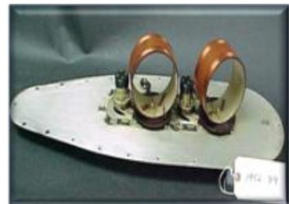
**Figure I.3:** Antenne cadre.
