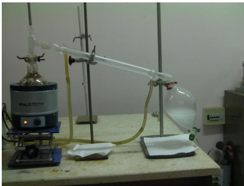
Fig. 8 : Montage de l'hydro distillateur réalisé au département de Chimie industrielle à l'université de Blida (Originale, 2013).
