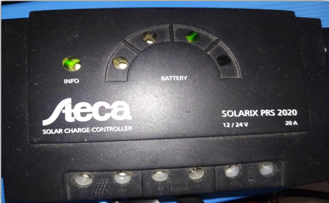
*Figure III.14 Régulateur Steca Solarix PRS 2020*
