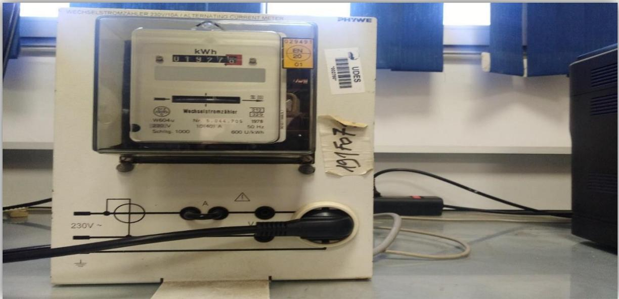
*Figure III.11 Compteur électromécanique*
