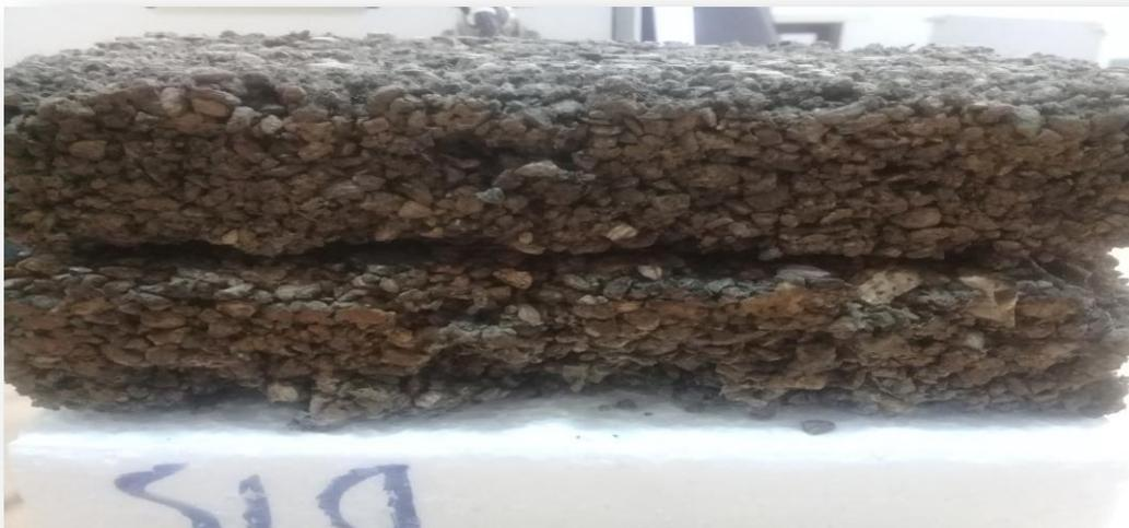
Figure 2.25 : TROUS D'AIR ENTRE LES DEUX ÉPROUVETTES
