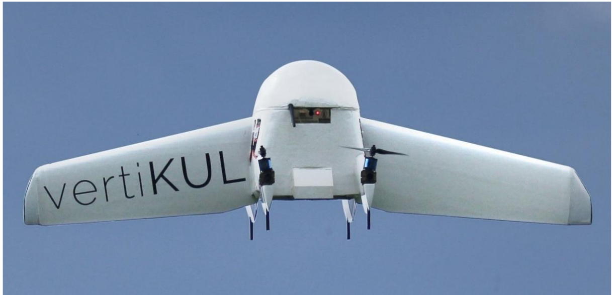
Figure 1.18 : drone à fuselage rotationnelle (Tilt-Body) [11].
