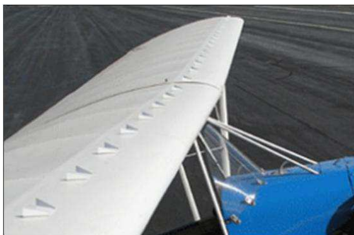
Fig. I-5 : Illustration d'un générateur de vortex passif installé sur Stewart Headwind
