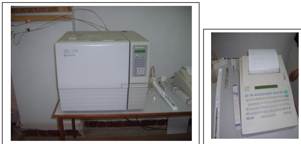
**Figure 3.10:** Appareillage de la (C P G) (Alphyt, 2012)
