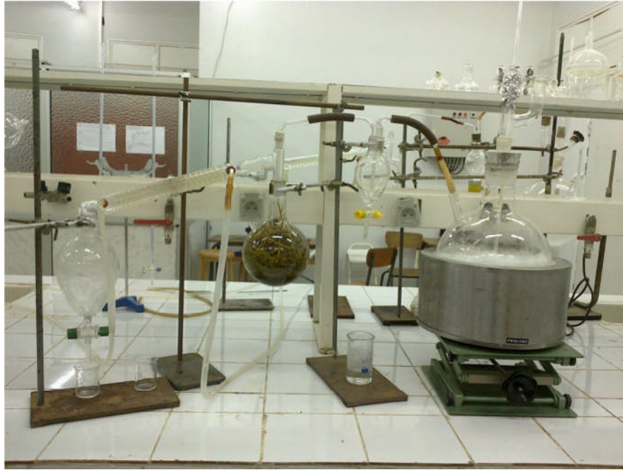
Fig. 13: dispositif d'extraction des huiles essentielles par entraînement à la vapeur d'eau (Originale).
