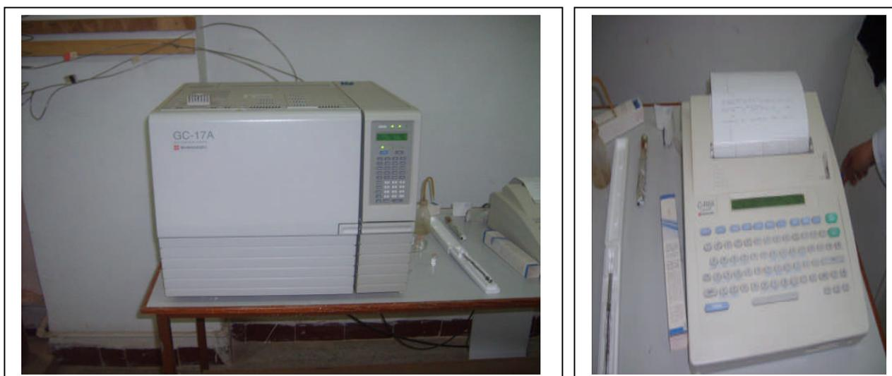
**Fig.21** : Photo de l'appareil utilisé dans l'analyse chromatographique CPG.
