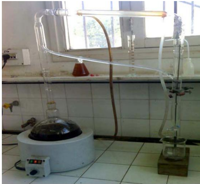
Fig18: dispositif d'extraction des huiles essentielles par Hydrodistillation (Originale).
