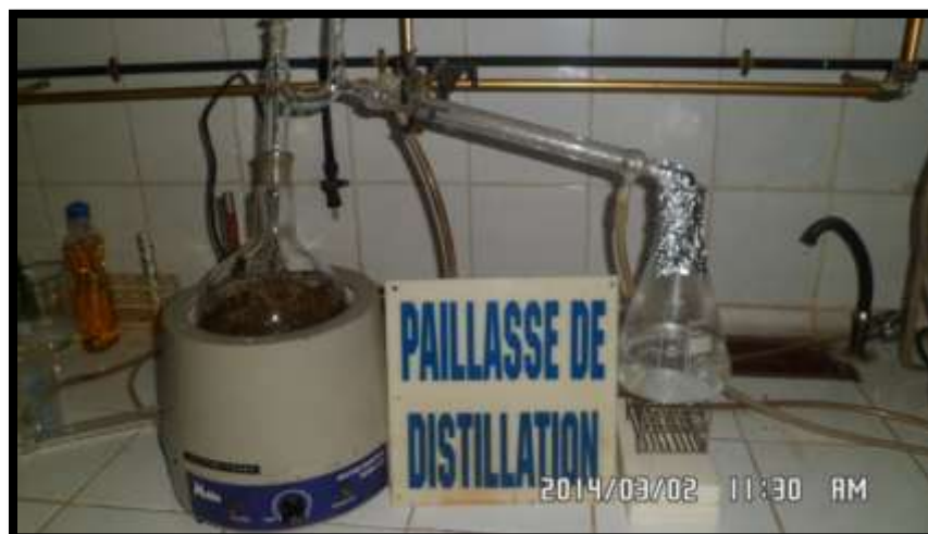
Figure 5: Extracteur d'huile essentielle par hydrodistillation (SAIDAL CRD, 2014)
