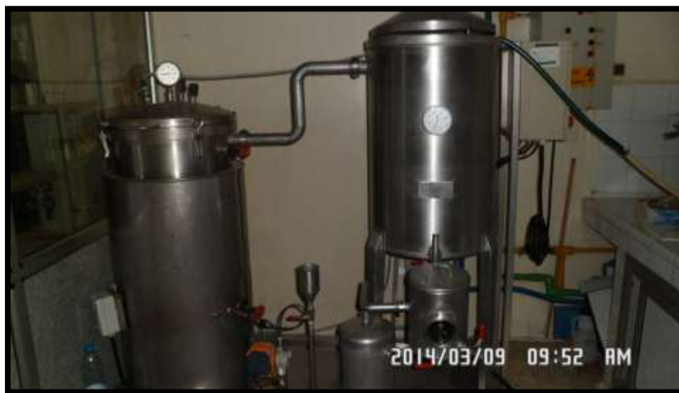
Figure 4: Extracteur d'huile essentielle par entrainement à la vapeur d'eau au niveau de pilote (SAIDAL CRD ,2014)
