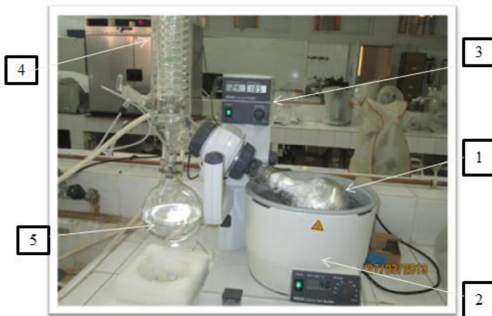
(1)le ballon contenant le solvant (2) le bain-marie chauffé à 40°C (3) vitesse de 75 tours/ mn, (4) réfrigérant (5) le ballon réceptacle
