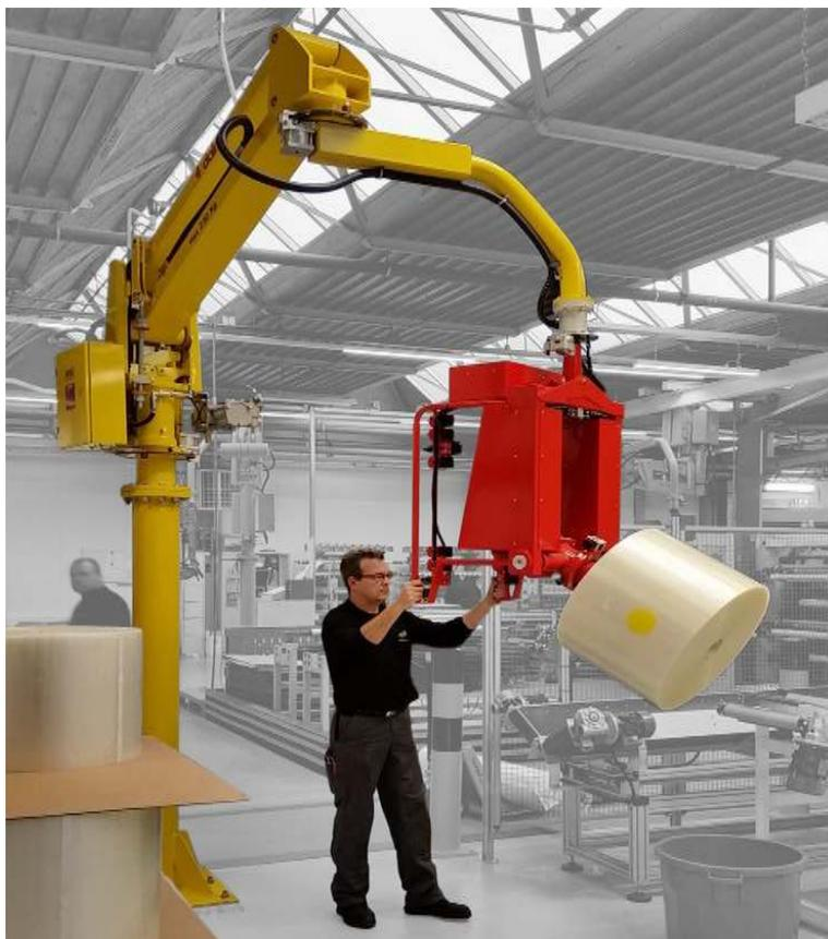
*Figure 1.15.* Manipulateur à commande semi-automatique . [10].
