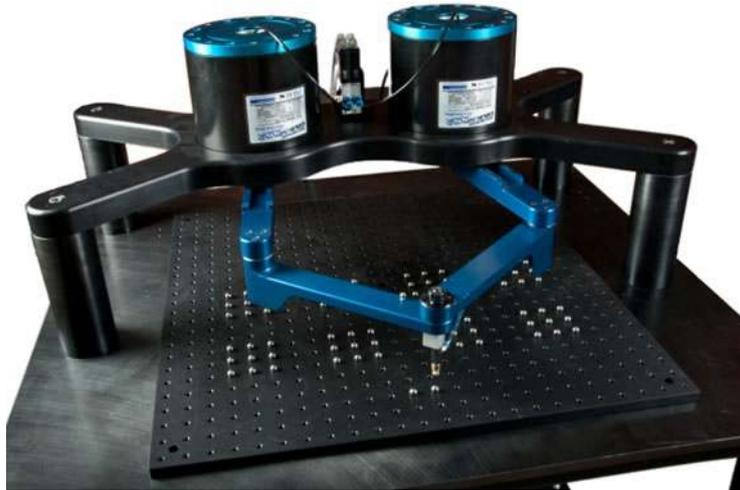
*Figure 1.13.* Robot parallèle. [18].
