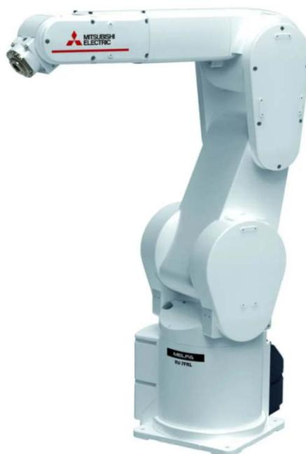
*Figure 1.14.* Robot articulé. [19].
