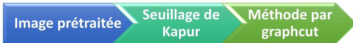
Figure 4-14: Schéma synoptique de la segmentation
