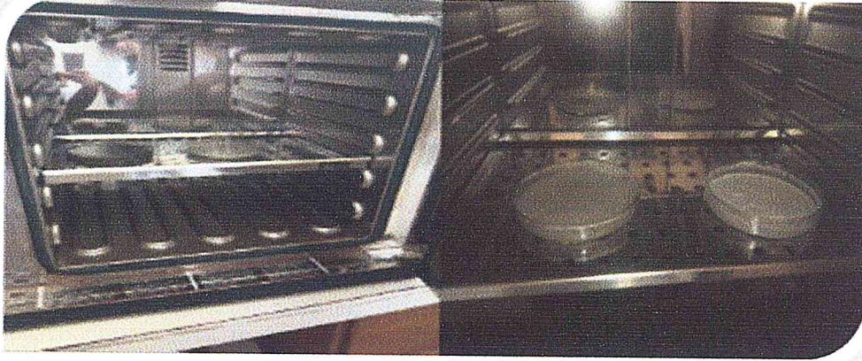
Figure IV.13 : Séchage de phosphogypse dans une étuve
