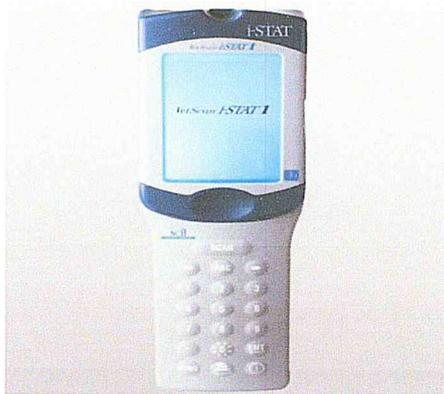
Figure 1.2. Analyseur microfluidique portable de la marque i-STAT
