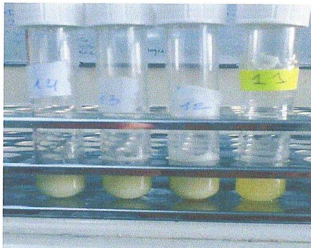
**Figure 47:** Tubes à essai après le dosage de : (L'alginat + TA +solution de dosage « L'huile »).
