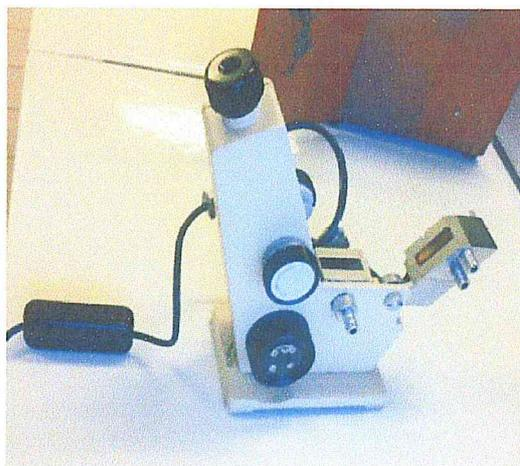
Figure 21: refractomètre
