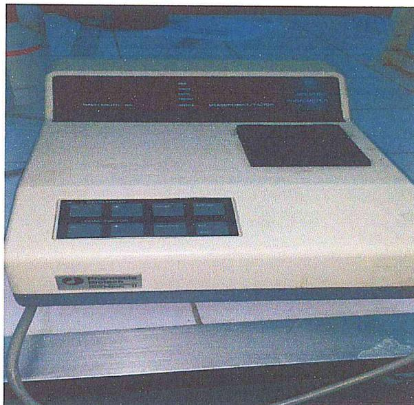
Figure 18:spectromètre UV/visible.
