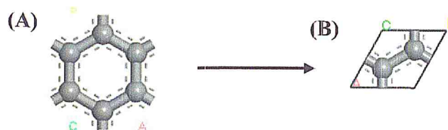
Figure III-1 : (A) La structure hexagonale et (B) la cellule primitive du graphène
