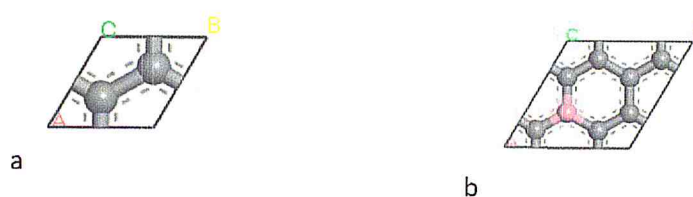
Figure IV.8: a) la structure du graphène pur. b) la structure du graphène dopé bore (12.5%)
