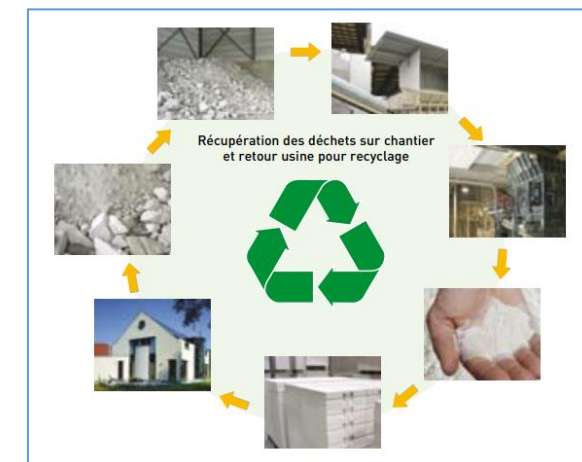
Figure 126 : cycle de recyclage du béton cellulaire Source : FebCel 2017
