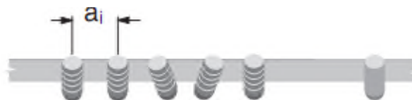
Figure (3.6) L'écartement minimal entre les stations suspendues.
