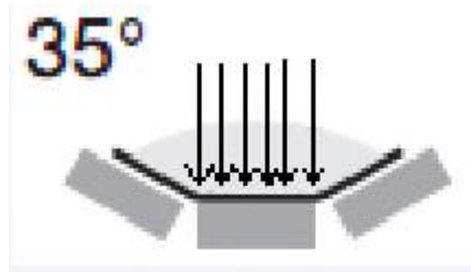
Figure (3.12) L'effort sur le rouleau central d'une station porteuse supérieure.
