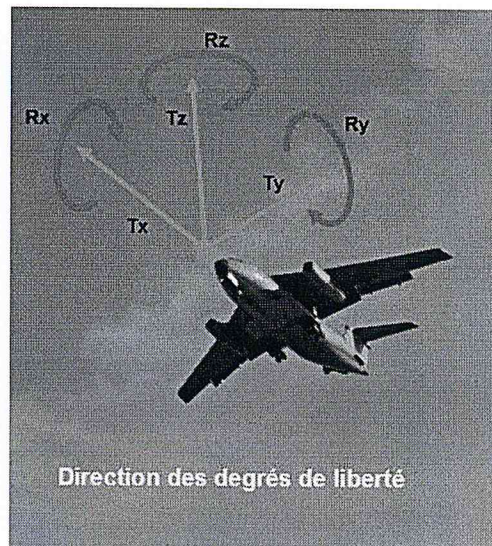
[Figure 1] Un objet solide possède 6 degrés de liberté
