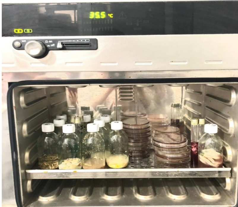
Figure 13 : incubation des boites dans une étuve à 36°C
