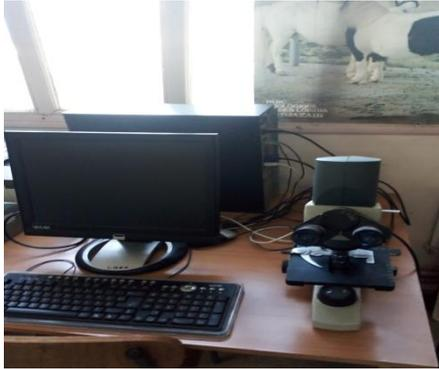
Figure 34 : microscope à camera lié à l'ordinateur + Logiciel MOTIC
