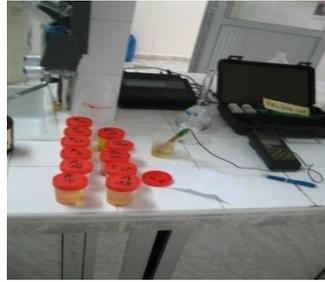
Figure 4.6: Mesure de pH à l'aide de pH-mètre.
