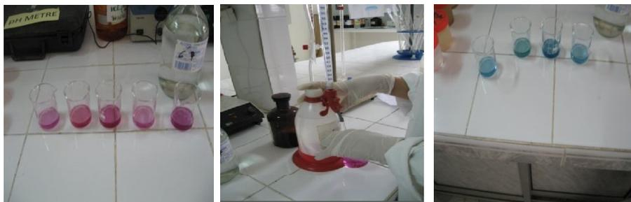
Figure 4.5: Analyse de laboratoire; la dureté.
