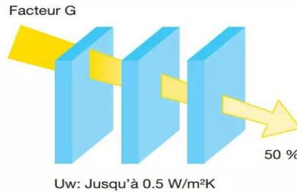
Figure 179: facteur de chaleur d'un triple vitrage source:....
