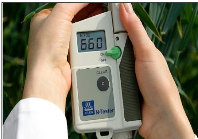
Figure 3.20 : Photo de YARA N-TESTER pour le diagnostic la nutrition azotée
