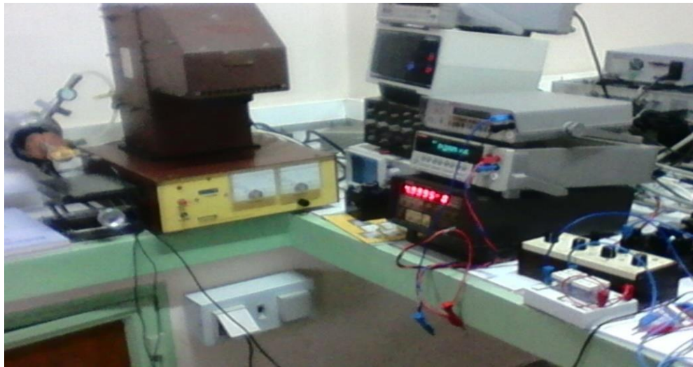
Figure 5. 3: Images de l'ensemble du montage expérimental pour les mesures (I-V) (LPMCER)-MAROC.
