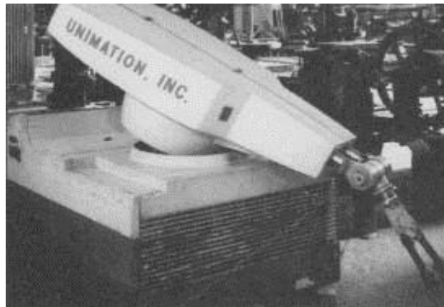
Figure 1 : Premier robot Unimates en fonderie sous pression en 1961 chez GM
