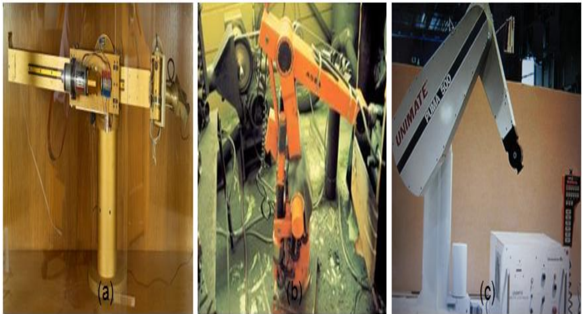
Figure 2 : (a) Robot Stanford (1969), (b) ASEA Robot IRB-6 (1974), le premier tout-électrique & (c) PUMA500 (1978), le robot travaille en coopération avec des opérateurs
