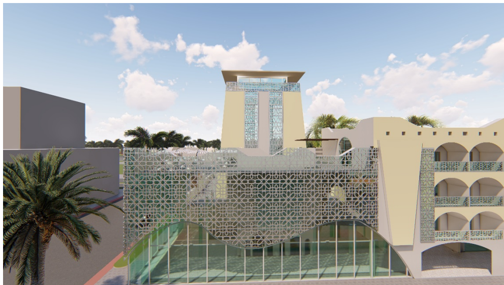
FIG 5.55 : le système des moucharabiehs Source : Auteur 2020
