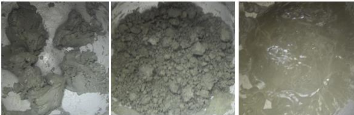
Figure 3.6 : Passage de l'état de boulettes à l'état de pâte homogène.
