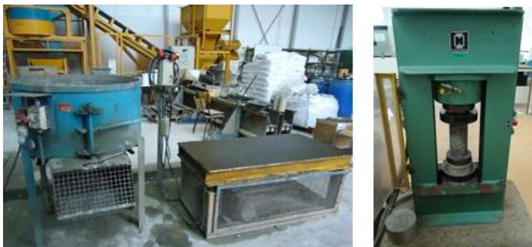
Figure 3.32 : Malaxeur, table vibrante et presse hydraulique (Perrier/3R) pour béton.
