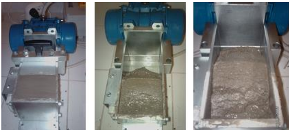
Figure 3.16 : Essais sur la consistance du mortier au Maniabilimètre B.
