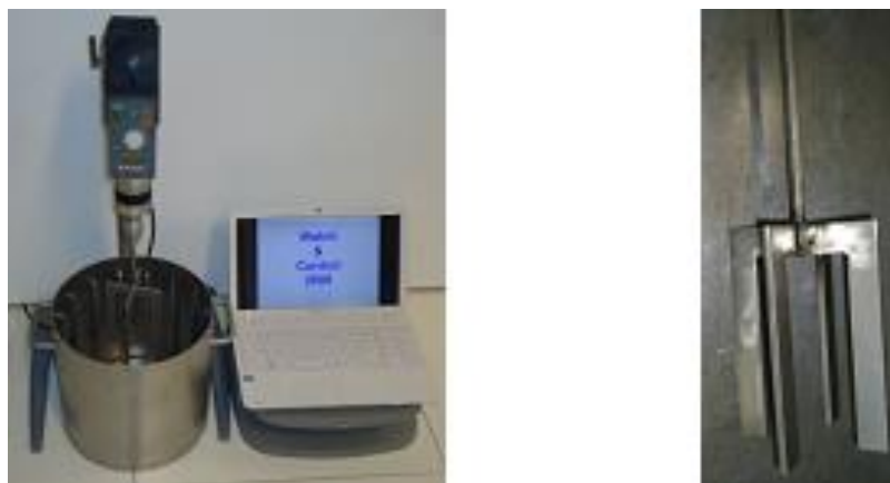
Figure 3.29 : Photo du rhéomètre à béton et la pale (double U)
