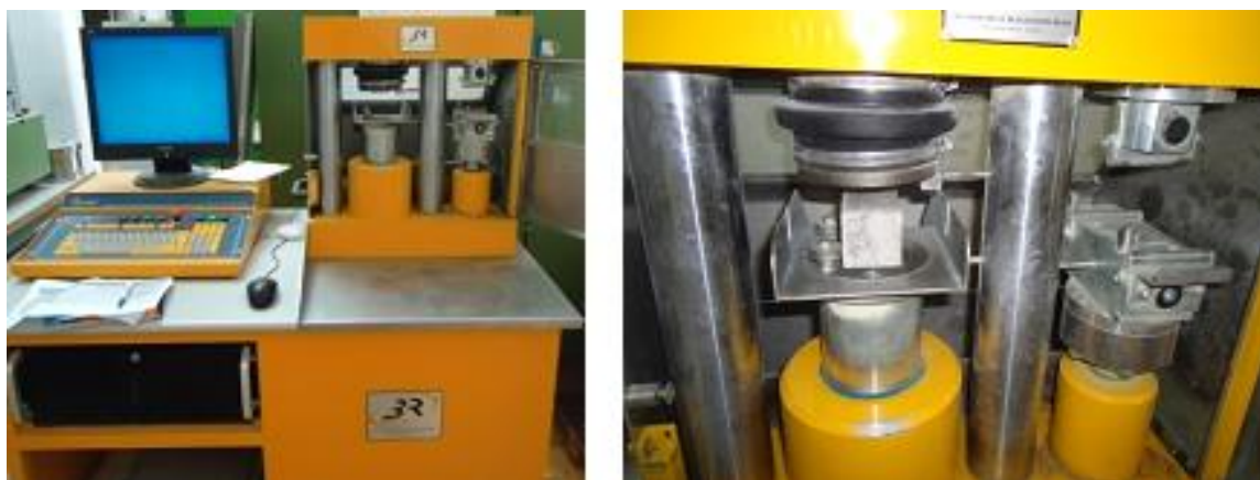
Figure 3.31 : Presse hydraulique pour mortier (Quantech 3R).
