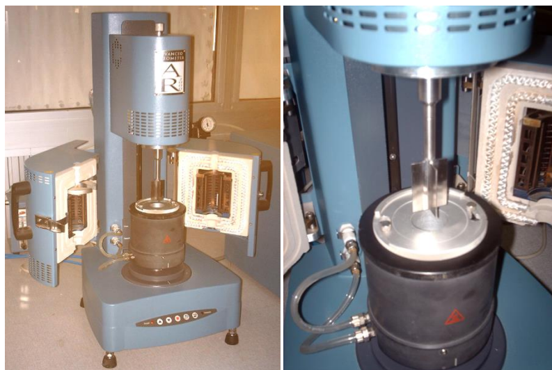
Figure 3.10 : Image du Rhéomètre AR 2000 avec la géométrie Vane.
