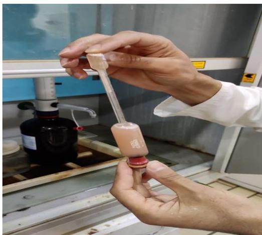
**Figure n° 5 : Butyromètre.**
