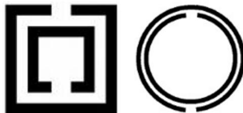
Figure II-1 Split Ring Resonator de type « carré et rond »
