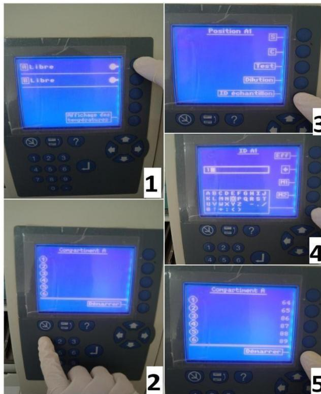
**Figure 6 :** Image des différentes étapes d'introduction d'informations de l'échantillon dans le système ('originale', 2020).
