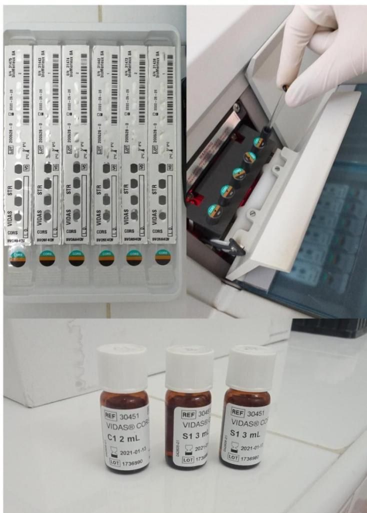
**Figure 5 :** Image qui représente les cartouches CORS (STR), les cônes CORS (SPR) et les flacons de calibrateurs plus le flacon de contrôle ('originale', 2020).
