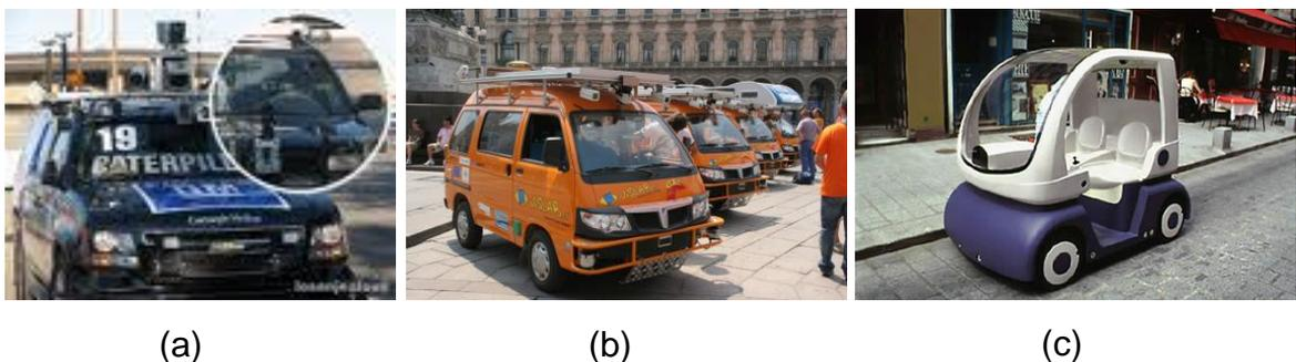
Figure i : Des véhicules sans conducteur. (a) Véhicule *Boss*, vainqueur du DARPA Urban Challenge 2007, (b) véhicules du VISLAB Intercontinental Autonomous Challenge (2010), (c) *Cycab*, Inria.
