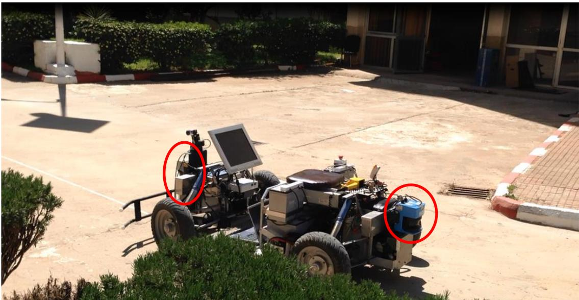
Figure 5.1 : Le robot mobile *Robucar* (les deux cercles rouges désignent les deux capteurs laser).
