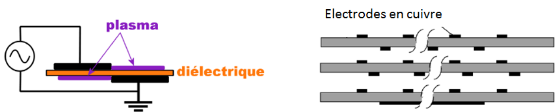
Figure 2.16: Configuration des électrodes utilisées par Roth pour établir la « OAUGAP », [48]
