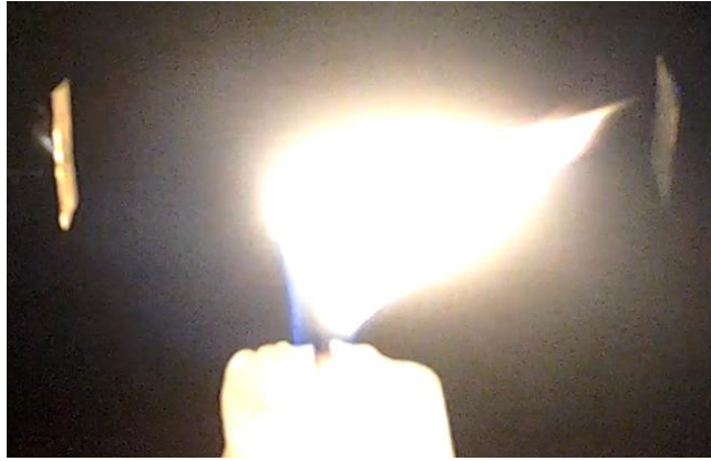
Figure 2.22 : Flamme d'une bougie soufflée par un vent ionique [86]
