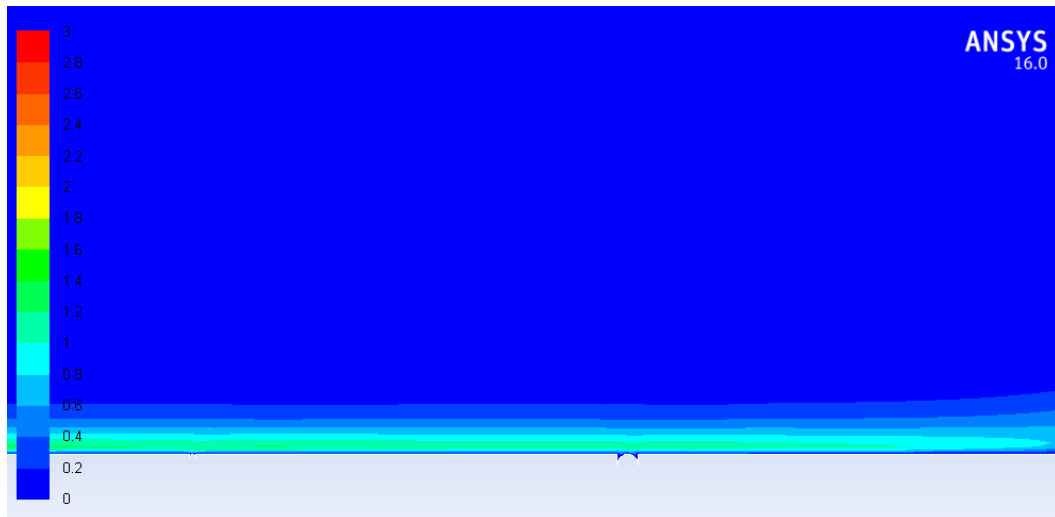
Figure 4.35 : Distribution des vitesses sur le système pour U_0= 0 m/s, \Delta V=32 kV
