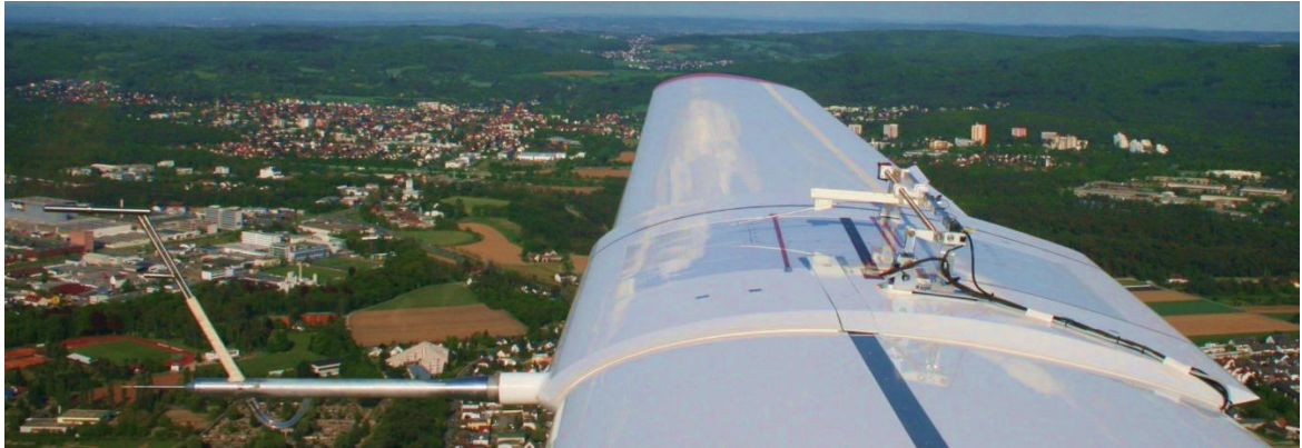
Figure 2 : Montage expérimental d'un actionneur EHD sur l'aile d'un planeur motorisé « Grob G109B » [3]
