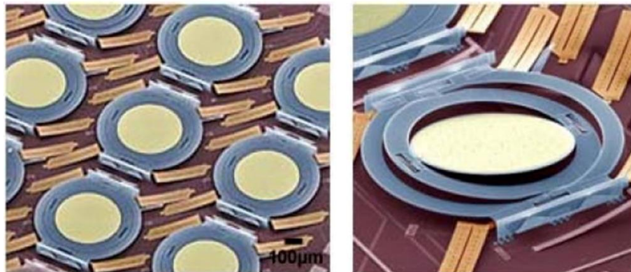
Figure 1.9 : Un réseau de 256 micromiroirs optique MEMS lie les informations à travers un faisceau laser entre les 256 entrées/sorties des fibres optiques [27].
