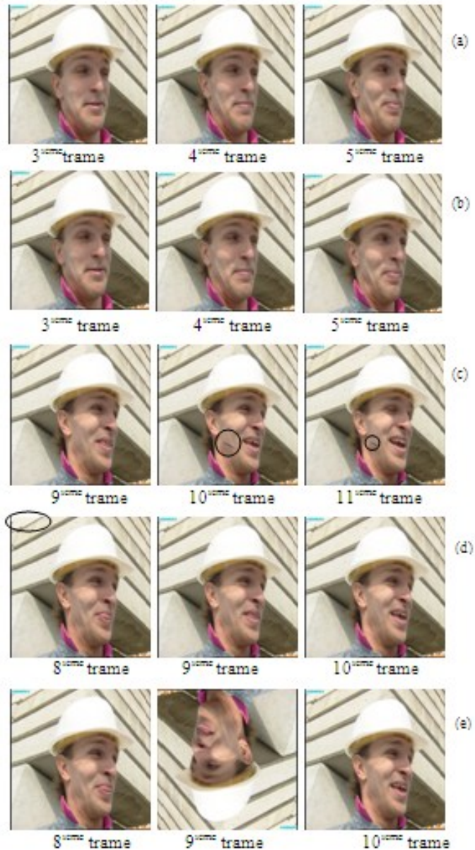
Figure 4.20 : Trames du 1 er GOP de la séquence Foreman: (a) trames d'origine, (b) trames tatouées, (c) attaque par DC, (d) attaque de cadrage et (e) attaque de rotation.
