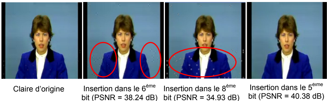
Figure 3.7 : Vidéo « Claire » tatouée à différentes positions des bits du coefficient Xq(3,3) sélectionné pour l'insertion.
