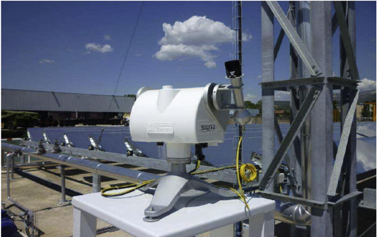
Figure 5.11 : pyréliomètre pour la mesure du DNI
