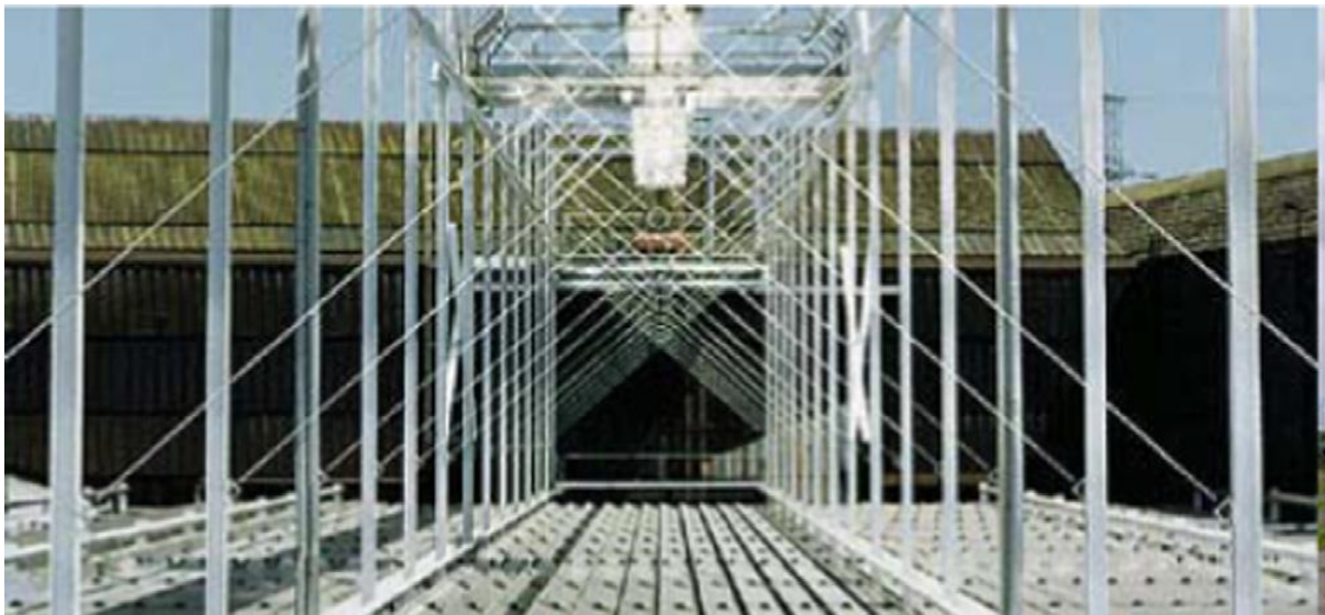
Figure 2.5 : Prototype de collecteur linéaire de Fresnel par Solarmundo, Belgique
