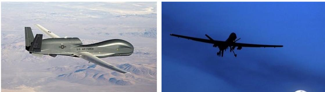
**Figure 1.10** : Exemples des drones HALE : (a) *RQ-4B Global Hawk* - (b) *RQ-180 Sentinel*
