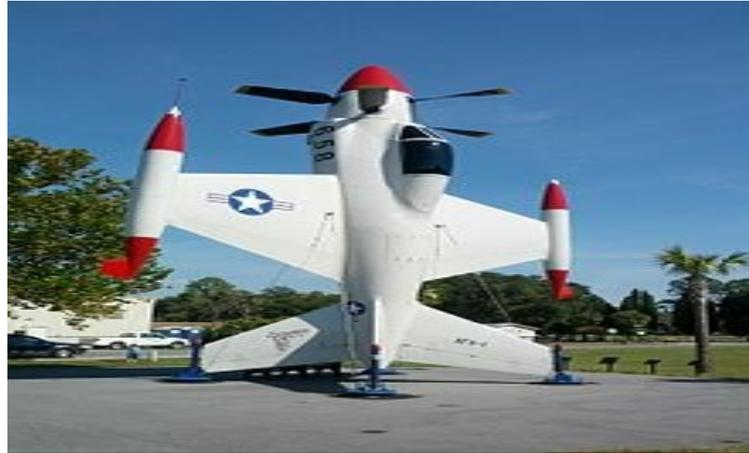
**Figure 1.6** : Exemples des Tailsitters : *Lockheed XFV-1*
