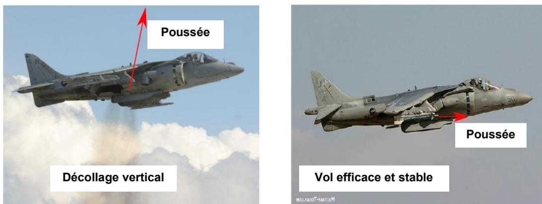
**Figure 1.7** : Convertibles à poussée basculée : (a) Décollage vertical - (b) Vol de croisière
