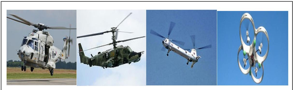
**Figure 1.3 :** Exemples d'hélicoptères : (a) Hélicoptère classique - (b) Hélicoptère à rotors coaxiaux - (c) Hélicoptère à rotors en tandem - (d) Quadrirotor
