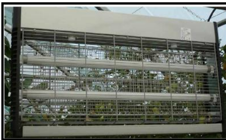
Figure 2.11 : Piège lumineux pour la capture des adultes de Tuta absoluta [38].
