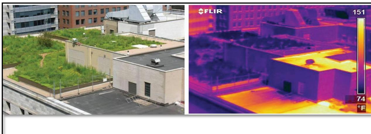
Figure 25 Mesure de la différence de température entre une toiture classique et une toiture végétalisée source : spécifiée non valid
