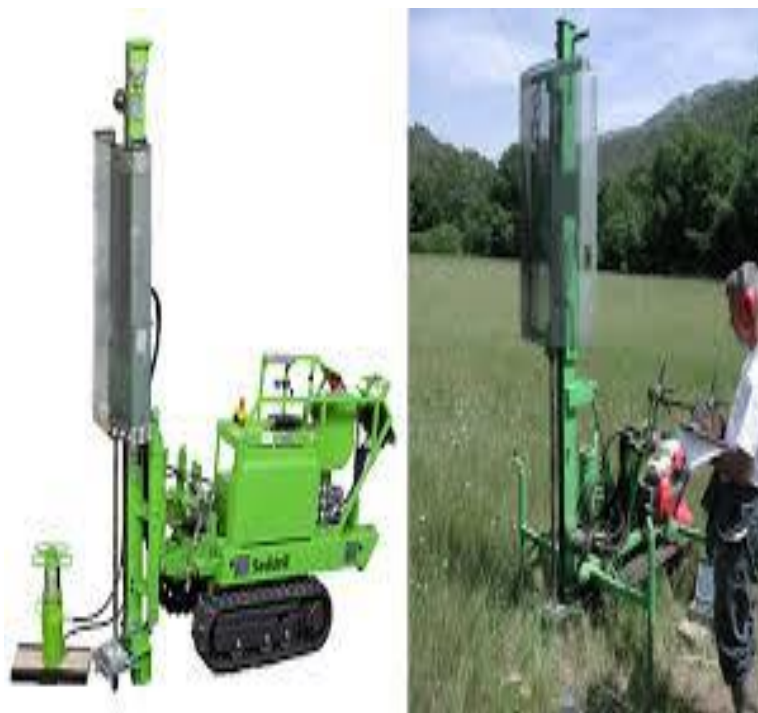
Figure II.7 : Principe de pénétromètre dynamique.
