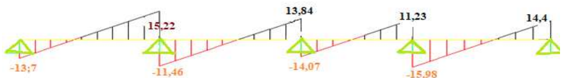
Figure .III.11: Moment fléchissant, Effort tranchant de la poutrelle à 04 travées
